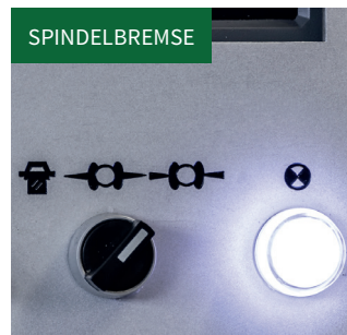
SPINDELBREMSE Schwenkbares Steuerpult für komfortable Handhabung mit integrierter 3-Achsen Digitalanzeige.
