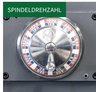
SPINDELDREHZAHN Fein abgestimmtes 18-stufiges Hauptspindelgetriebe mit Drehzahlen von 40 - 2000 U/min mit direkter Kraftübertragung.
