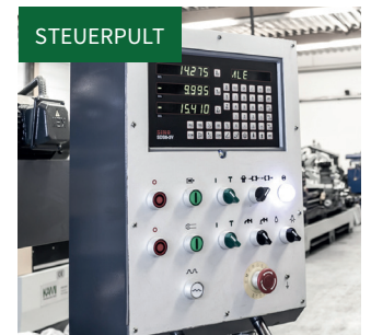
STEUERPULT Schwenkbares Steuerpult für komfortable Handhabung mit integrierter 3-Achsen Digitalanzeige.
