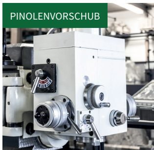
PINOLENVORSCHUB 3-stufiger automatischer Pinolenvorschub mit 0,03 / 0,06 / 0,12 mm/U.
